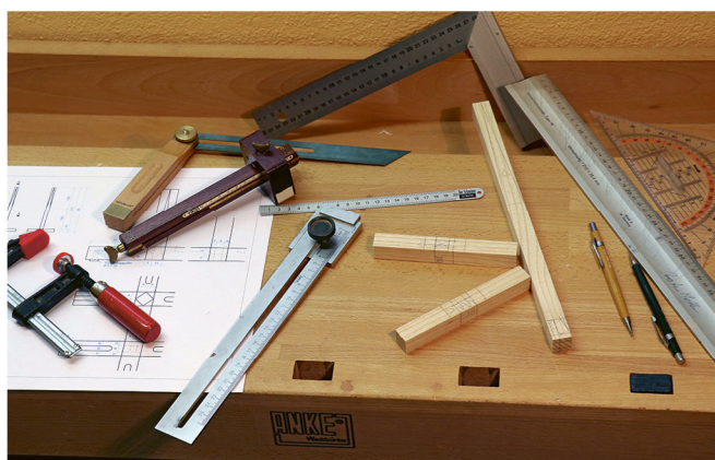
Die fertig gerissenen Friese können nun bearbeitet werden.
