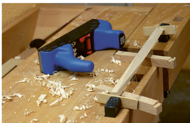
Der Fries wird zum Hobeln in die Bank eingespannt.
