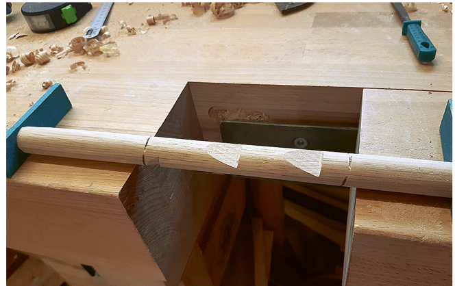
Der gehobelte Rundstab wird vor dem Ablängen sauber geschliffen.
