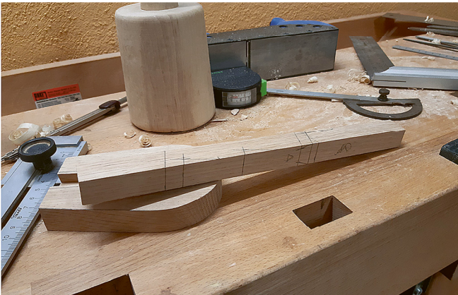
Stab nach der Reissarbeit, vor dem Rundhobeln.
